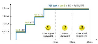
com o auxílio de uma medição de descarga parcial, são mostrados e localizados com precisão os pontos de defeito de DP. O destaque no MWT é a duração do teste baseada no estado: Desde que permitido, a duração do teste pode ser reduzida, o que reduz os custos. Assim o cabo é submetido à maior tensão de teste somente pelo tempo necessário.
