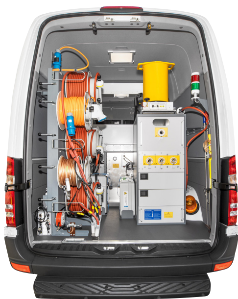
Exemplo de integração no veículo para teste de cabos
